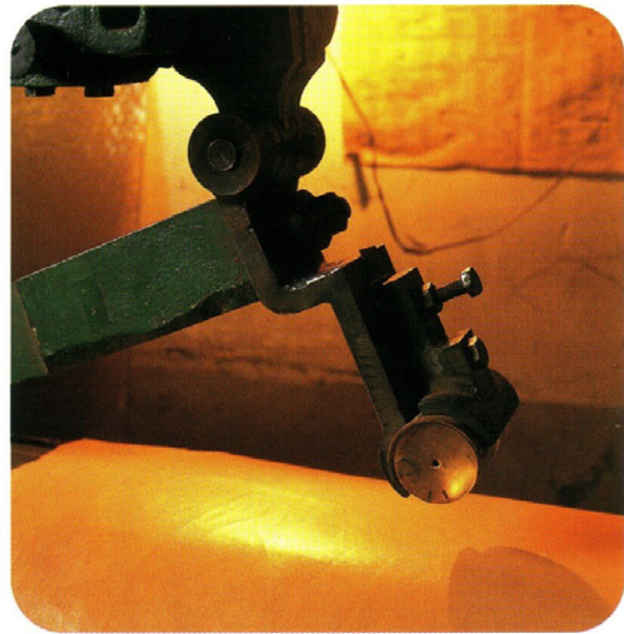
Rodillo de vidrio para el abrillantado de las pieles.
