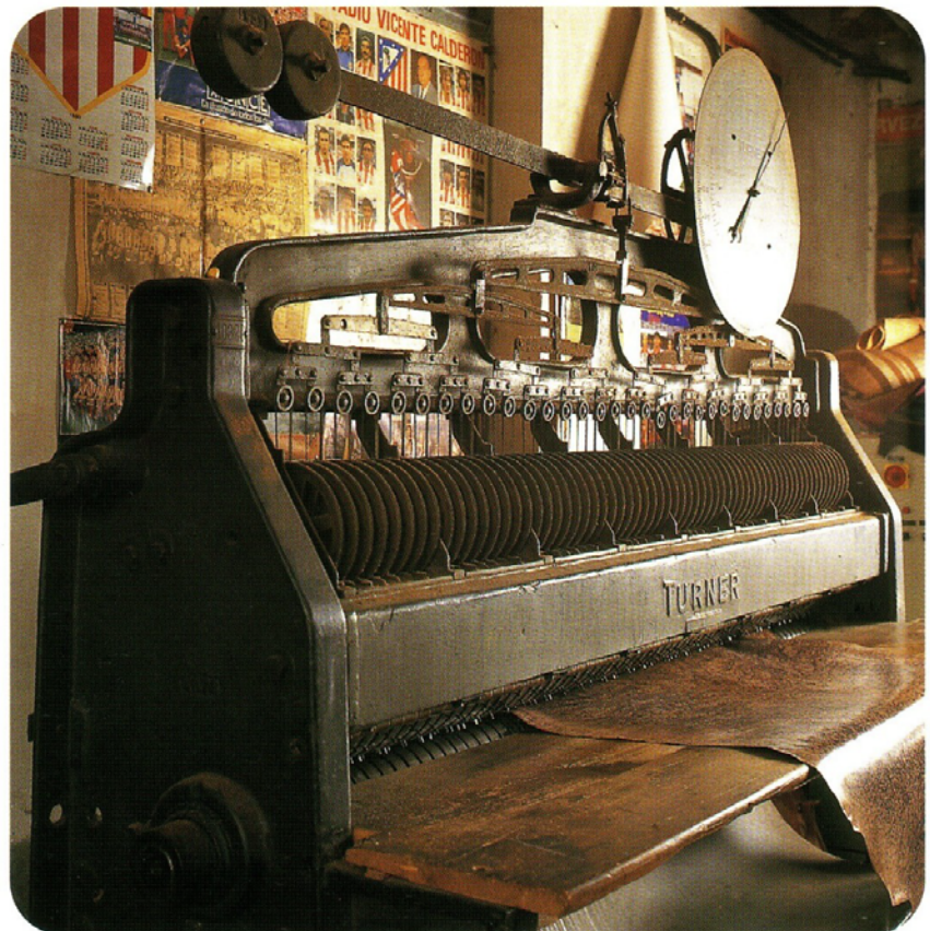
Máquina de agujas para obtener, en pies, las medidas de las pieles.
